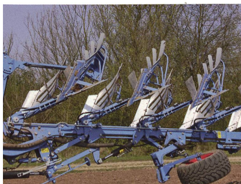
Tous les réglages des nouvelles charrues Juwel sont directement modifiables depuis la cabine.
