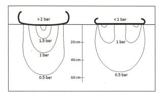
Cet exemple montre l'influence considérable de la pression des pneus pour un pneu large avec une charge par roue de 4 tonnes. A gauche la répartition avec pression élevée (> 2 bar), à droite avec pression faible (< 1 bar).
