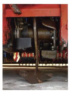
L'intégration de la sous-soleuse (à gauche) l'introduction partielle du Packer dans le boitier de fraisage constituent les principales évolutions qui permettent surtout un travail sans bourrage.
