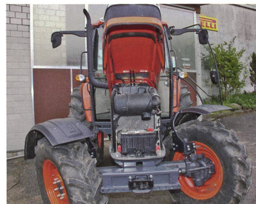
Le moteur est très facilement accessible, et la transmission par pignons coniques de la traction avant permet un braquage impressionnant.
