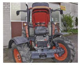
Le moteur est très facilement accessible, et la transmission par pignons coniques de la traction avant permet un braquage impressionnant.
