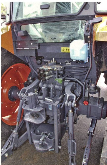
Les prises hydrauliques sont tournées vers la gauche pour faciliter les branchements.
