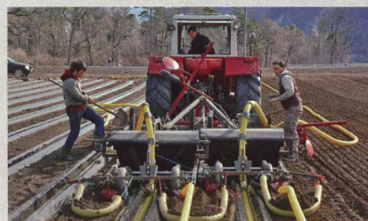
Grâce à la machine construite pendant de longues heures de travail par le chef d'atelier Christian Berther, les buttes sont formées et les tuyaux déposés conjointement.
