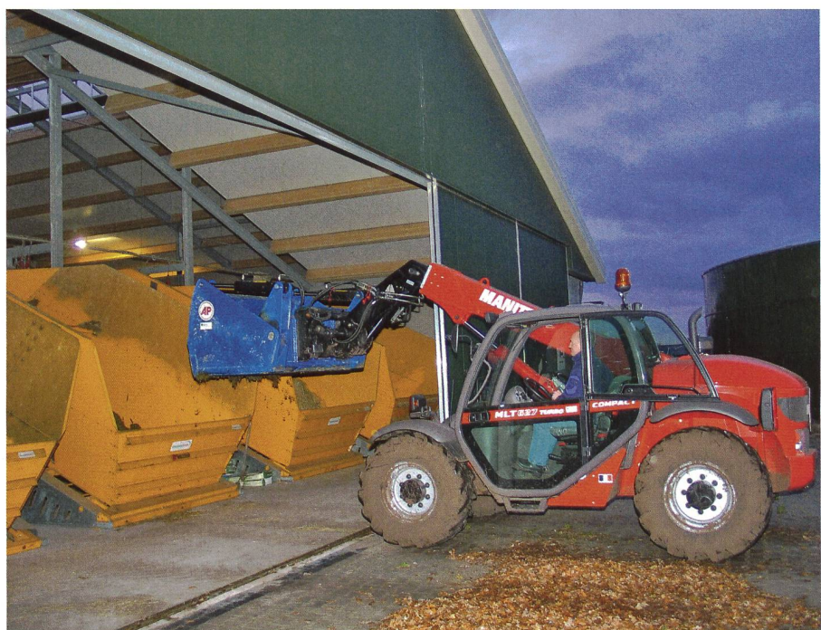
Remplissage d'un réservoir de stockage d'un système d'affouragement automatique.
