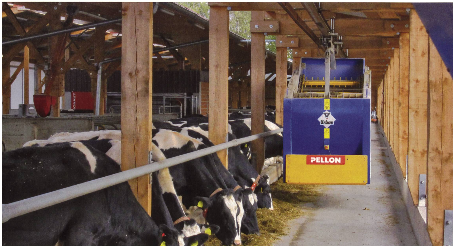
Système d'affouragement sur rails pour la distribution du fourrage (Pellon).
