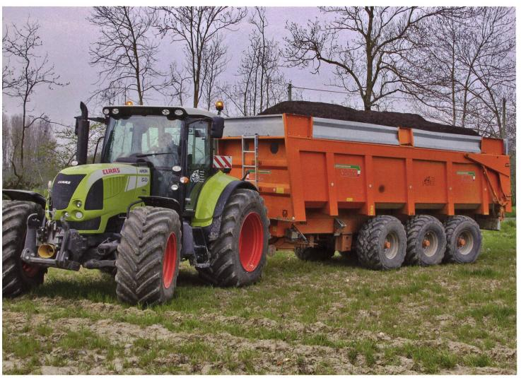
Les limites du poids autorisé sont atteintes par une répartition optimale des charges sur le tracteur (charge sur le timon) et sur les essieux de la remorque (charge remorquable). (Photo: Gaël Monnerat)
