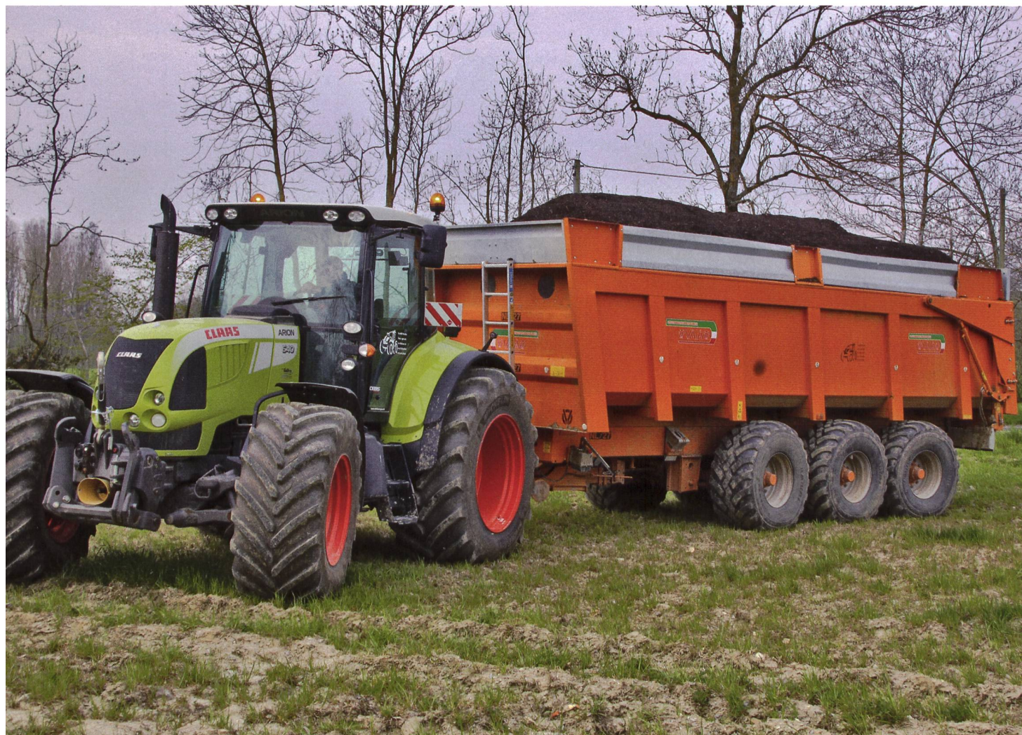
Les limites du poids autorisé sont atteintes par une répartition optimale des charges sur le tracteur (charge sur le timon) et sur les essieux de la remorque (charge remorquable). (Photo : Gaël Monnerat)
