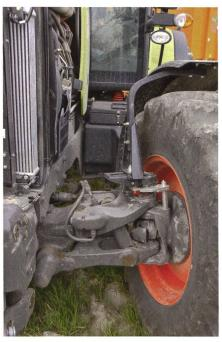
La suspension de l'essieu avant apporte un excellent confort sur route, même si les graisseurs sont nombreux.
