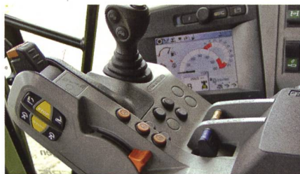
Les fonctions les plus utilisées sont regroupées sur l'accoudoir multifonction.
