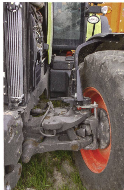
La suspension de l'essieu avant apporte un excellent confort sur route, même si les graisseurs sont nombreux.
