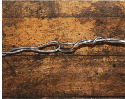
Les nœuds plats (gauche) assurent un meilleur contact que les boucles (droite).
