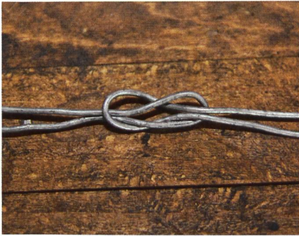
Les nœuds plats (gauche) assurent un meilleur contact que les boucles (droite).
