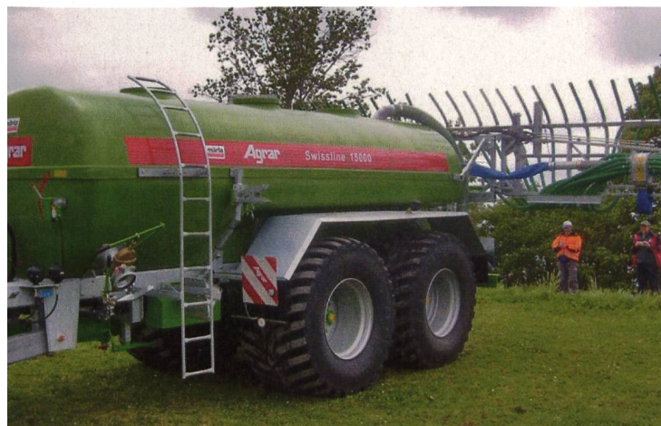
Procédé en une phase: souplesse en matière de transport et d'épandage grâce aux capacités de remplissage, à un train roulant préservant le sol et à un système de répartition à pendillards.
