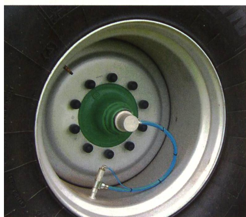
Dispositif de régulation de pression assurant le gonflage optimal autant sur route que dans les champs.
