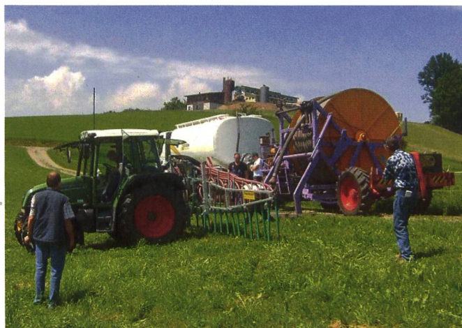
Procédé en deux phases: logistique en bord de champ avec capacités de transport maximales par camion. Les contraintes au sol sont minimales avec le répartiteur à pendillards.
