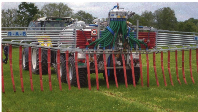
Pour que le lisier et ses composants atteignent l'endroit ciblé: avec répartiteur à pendillards comme solution standard ou...
