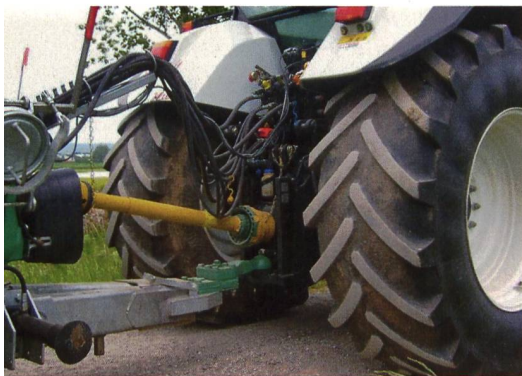
Attelage inférieur à boule: transfert maximum de la charge d'appui jusqu'à 3 tonnes sur le tracteur (sous réserve des conditions mentionnées en page 33).
