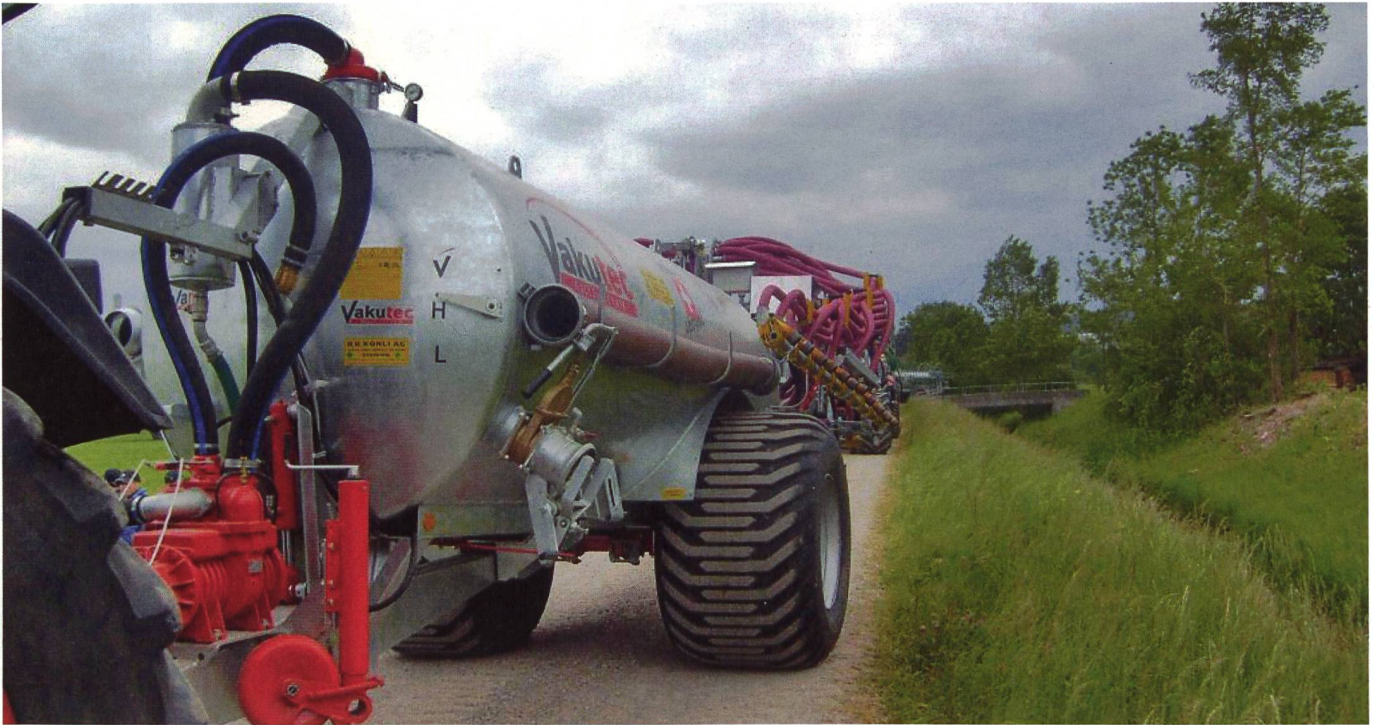
Tendance actuelle : davantage de charge utile, moins de pression au sol grâce aux pneus larges et un dosage précis. (Photos : Strickhof)
