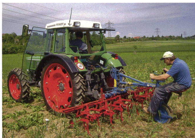
Utilisation d'une herse à socs perpendiculaire aux rangées de betteraves.
