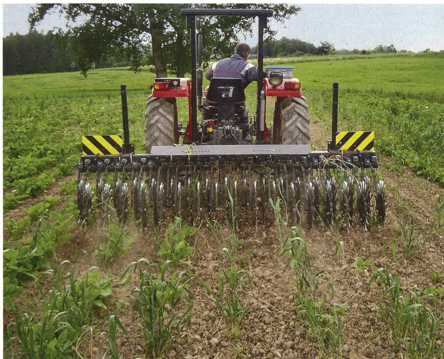
Utilisation d'une herse rotative « Yetter » dans les betteraves sucrières.
