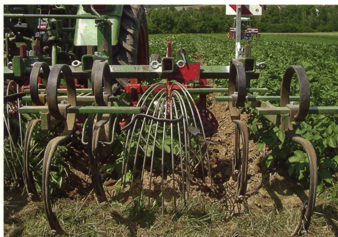
Sarcluse combinée pour les pommes de terre: sarcloirs entre les buttes et petits peignes sur les buttes.
