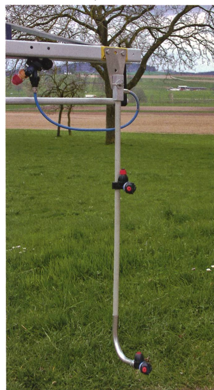
Droplegs avec des buses complémentaires enclenchables manuellement et placées à une hauteur de 60 cm.
