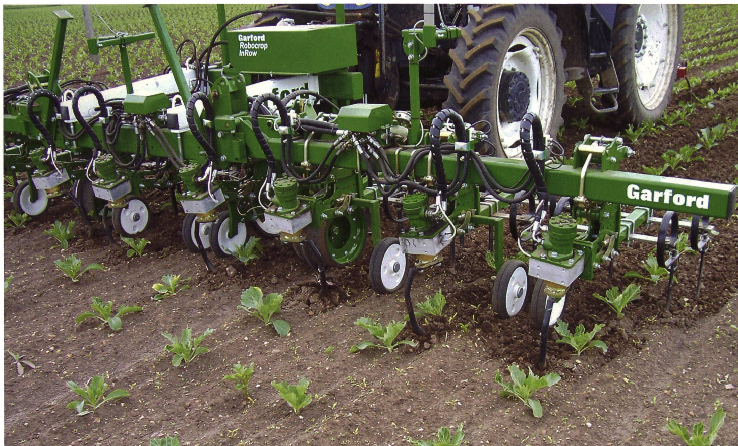
Système Robocrop InRow permettant la lutte contre les adventices à l'intérieur des rangs au moyen de capteurs. (Photo d'usine)
