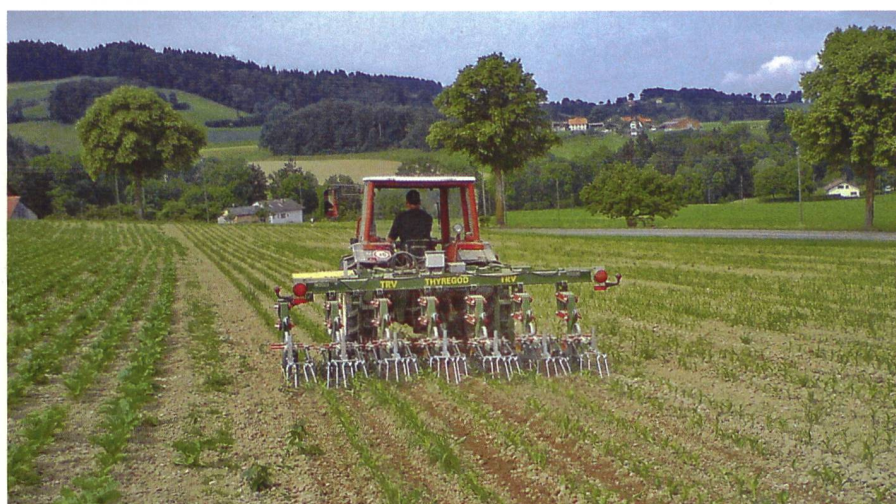
Grâce au guidage par caméra, le maïs peut être sarclé sans tierce personne.
