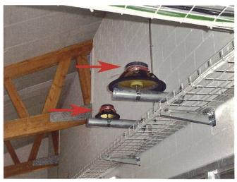
Fig. 1: Systèmes de haut-parleurs permettant de produire du bruit et des vibrations d'une intensité définie.
