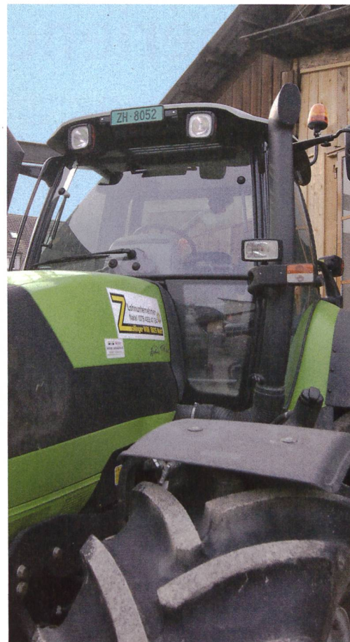
La prise d'air à hauteur du toit de la cabine de série limite la quantité de poussières aspirées.
