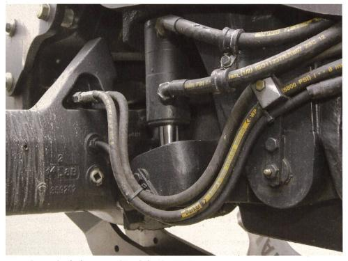
Suspension hydropneumatique de l'essieu avant.
