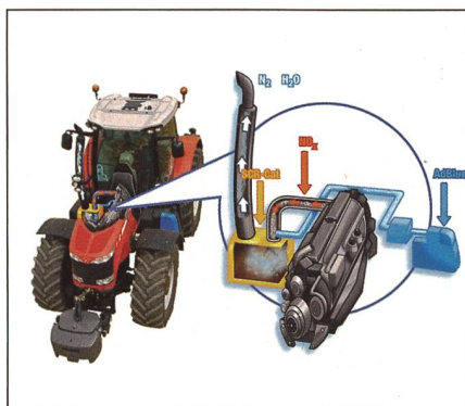
Principe de fonction de la technologie SCR pour le traitement des gaz d'échappement.
