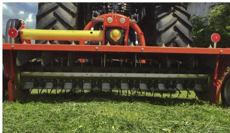
Les conditionneurs à fléau sont les plus répandus et les plus polyvalents. Une grande diversité de fléaux est disponible. (Photo : Fella et Agriott)
