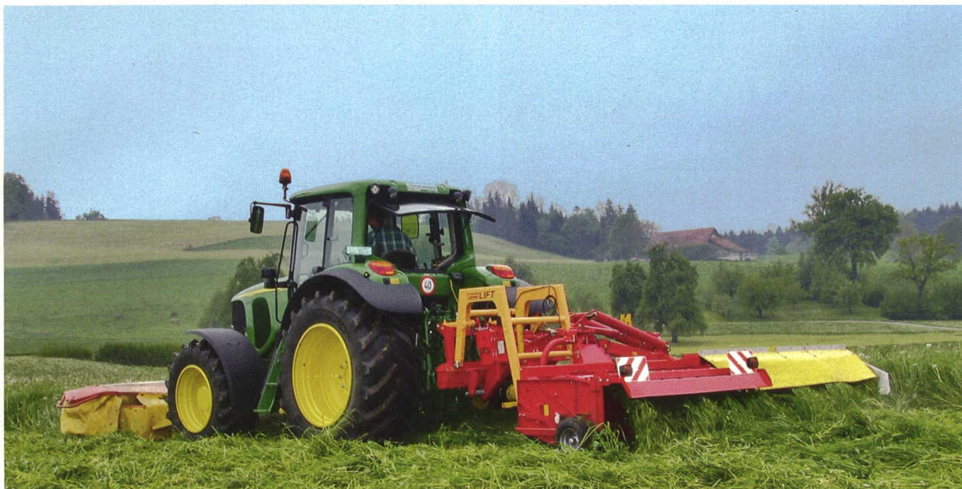
Le système HydroLift de Kurmann offre de nouvelles possibilités de combinaison pour la fauche. (Photo: Kurmann)
