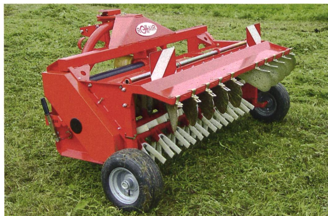
Les conditionneurs à fléau sont les plus répandus et les plus polyvalents. Une grande diversité de fléaux est disponible. (Photo : Fella et Agriott)
