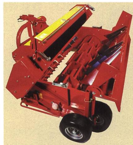
Les conditionneurs intensifs à brosse démontrent la meilleure efficacité de séchage. (Photo : Kurmann)
