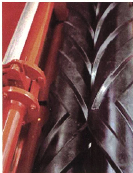
Les conditionneurs à rouleau exigent une bonne répartition du fourrage sur toute la largeur de travail pour développer tout leur potentiel. (Photo : Kuhn)
