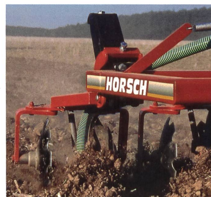
Le strip-tillage a été mis au point aux USA et s'installe progressivement en Europe. Des bandes sont ameublées en automne ou au printemps. Le maïs est ensuite semé dans ces bandes. L'objectif consiste à assurer un réchauffement rapide du sol et de favoriser ainsi le développement juvénile du maïs. (Photo : Firma Horsch, D-Schwandorf)
