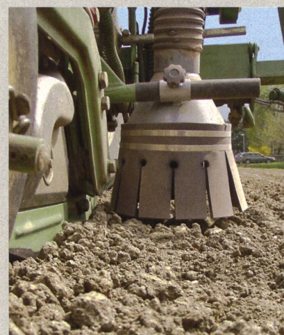
Les déflecteurs sont censés dévier l'air aspiré par les semoirs monograine à proximité immédiate de la surface du sol.
