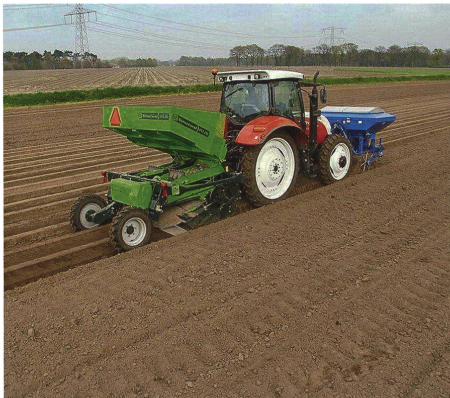
Hauteur de chute réduite des tubercules : caractéristique des planteuses à courroies.
