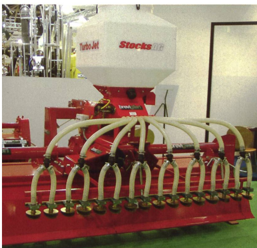
La combinaison de la herse rotative et du semoir est appropriée pour des réparations sur de petites surfaces.
