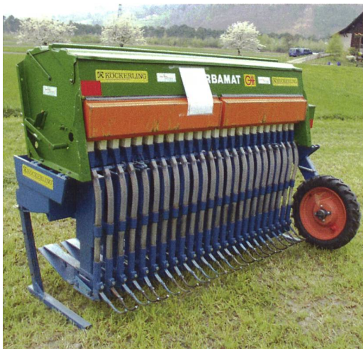
L'Herbamat assure un contact étroit de la semence avec le sol. Grâce à sa manipulation simple, cette machine est utilisable par un collectif d'exploitations.
