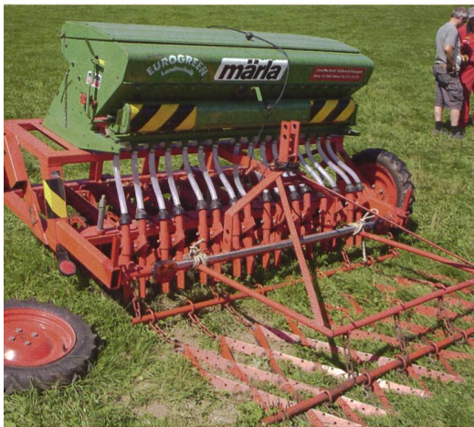
Cette combinaison de divers éléments de machines garantit, avec une grande fiabilité, le contact nécessaire de la semence avec le sol. (Photo: C. Jenni, Strickhof)
