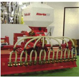
La combinaison de la herse rotative et du semoir est appropriée pour des réparations sur de petites surfaces.
