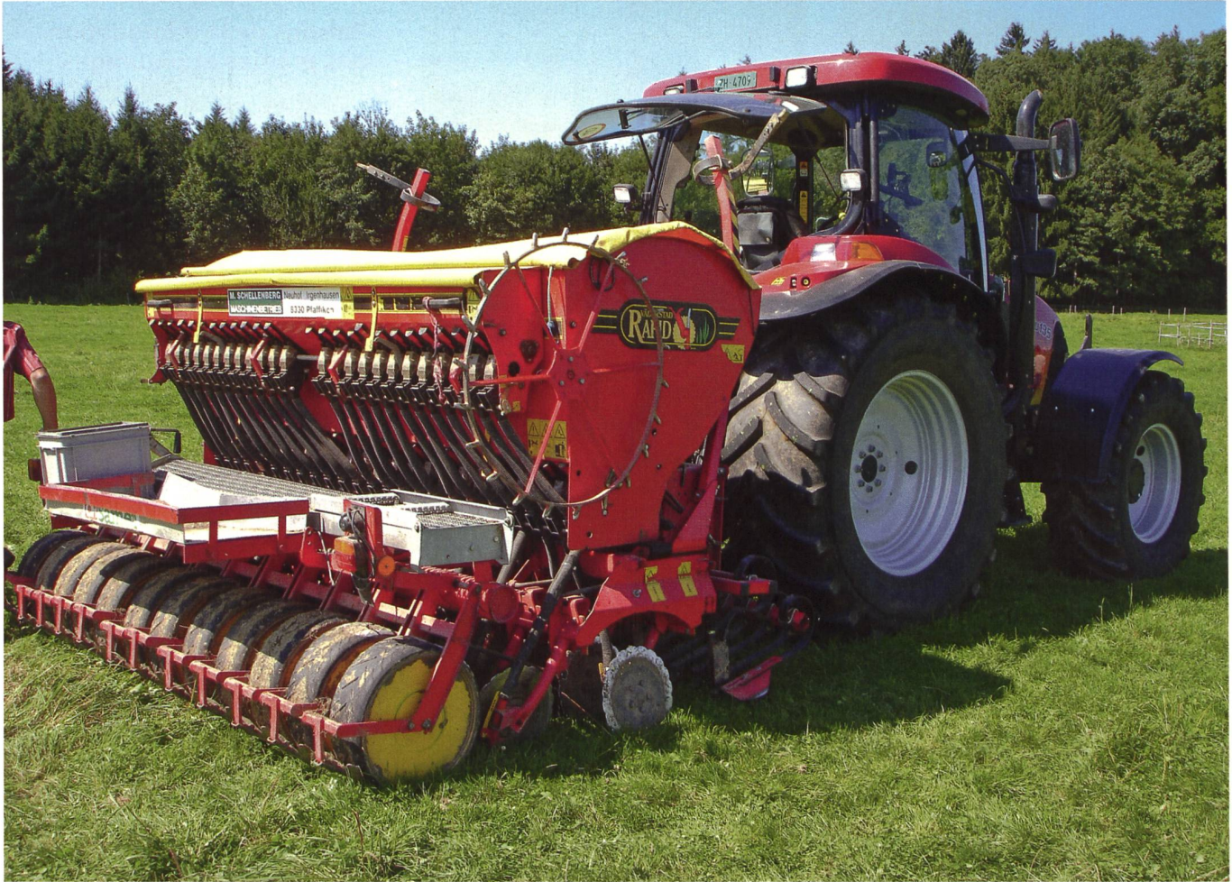
Les machines de semis direct sont bien appropriées pour la régénération des prairies. Elles assurent de bonnes conditions de germination.
