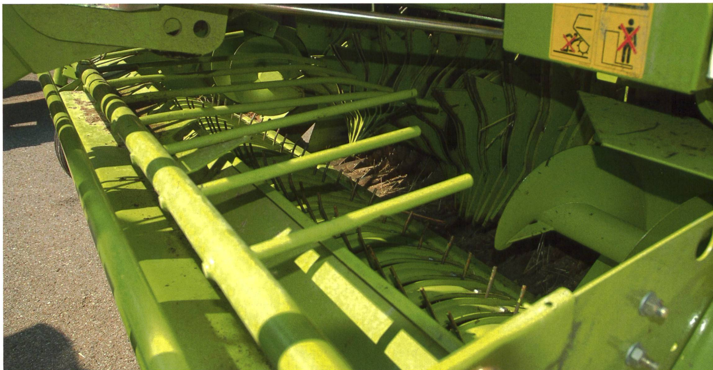
La construction de presses modulaires permet de choisir entre plusieurs largeurs de pick-up. Celui-ci, ainsi que les organes d'alimentation, déterminent les performances de la presse et la densité du fourrage. (Photos: Joachim Sauter ART, photos d'usine)
