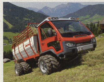
Transporteur Aebi TP450 : la suspension hydropneumatique offre un confort remarquable.
