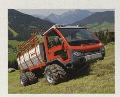
Transporteur Aebi TP450: la suspension hydropneumatique offre un confort remarquable.
