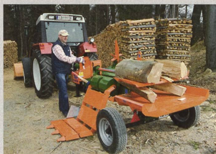
Fendeuse horizontale SplitMaster avec table de récupération des bûches.
