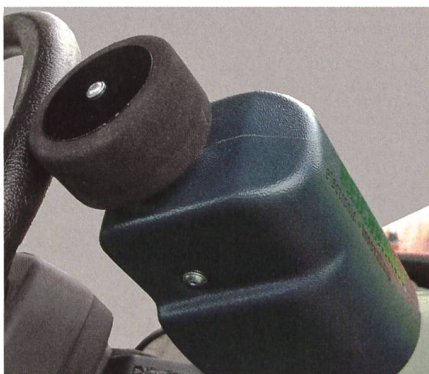
Fig. 7 : Variantes de systèmes actionnant le volant : à gauche « Reichhardt RDU » monté sur le volant, au milieu « JohnDeere AutoTrac Universal » comme volant de remplacement, à droite « Autofarm OnTrac2 » monté sur le support du volant existant.
