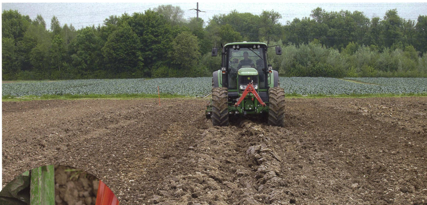
Fig. 1 : Avec des systèmes de guidage de précision, une exactitude de \pm 5 cm est possible pour la préparation du sol et le semis en grandes cultures.
