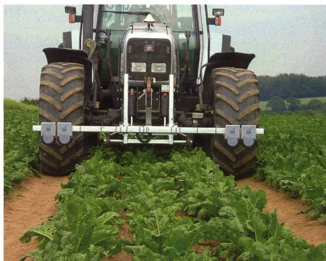
Fig. 5 : Systèmes de guidage en parallèle sans GPS : à gauche capteur ultrasons de Reichhardt Technique de guidage, détectant les voies de passage, à droite, le Claas-CAM-Pilot conduisant la herse entre les rangs.
