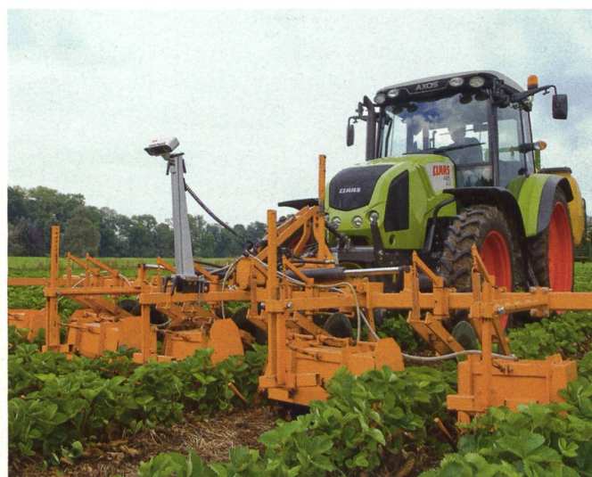
Fig. 5 : Systèmes de guidage en parallèle sans GPS : à gauche capteur ultrasons de Reichhardt Technique de guidage, détectant les voies de passage, à droite, le Claas-CAM-Pilot conduisant la herse entre les rangs.
