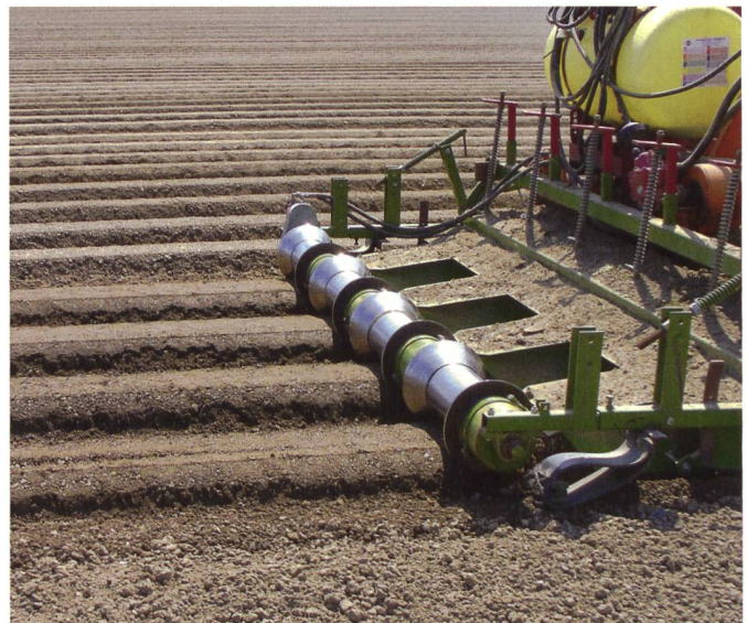
Fig. 4 : Guidages postérieurs. A gauche Trimble TrueTracker, à droite butteuse avec positionnement transversal guidé par GPS et commandé par cadre réglable hydraulique.
