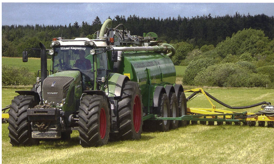
Enfouissement de lisier (en ligne), au Danemark d'après la méthode dite du « Controlled Traffic Farming ». Le tracteur circule par guidage DGPS et pilotage assisté toujours dans les mêmes traces. (Photo : Ueli Zweifel)
