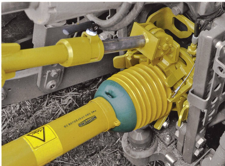
Couplage rapide: Le système Power-Lock facilite grandement l'attelage et le décrochage des machines proches du tracteur, surtout si l'opération est fréquente.
