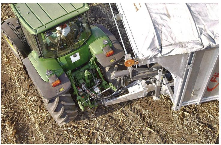
Le système «ForCon 2010» de Fliegl: Le gyroscope situé dans un boîtier, au-dessus de l'attelage (milieu de l'image), mesure le rayon de virage et transmet les informations au système, resp. aux vérins de l'essieu tridem directionnel.
