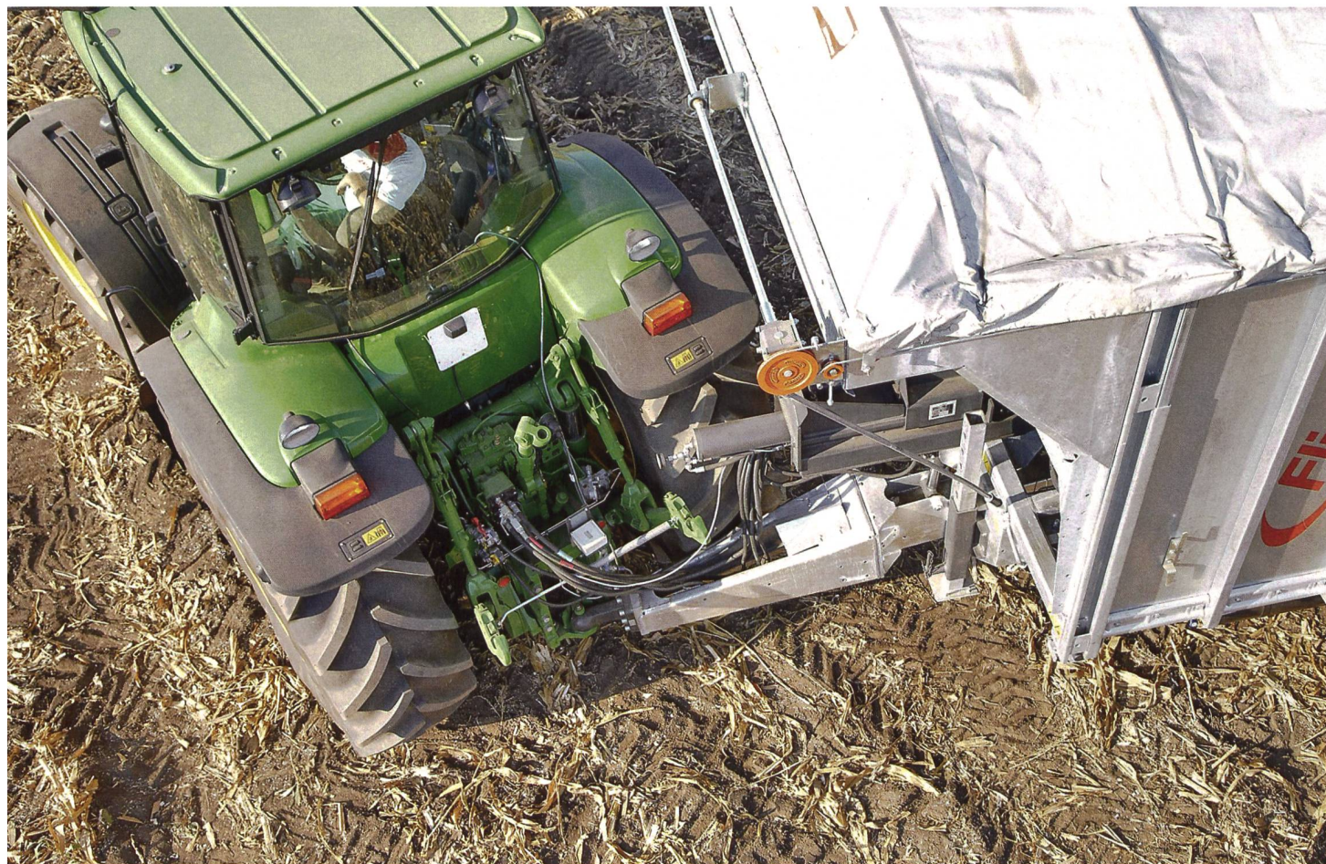
Le système «ForCon 2010» de Fliegl: Le gyroscope situé dans un boîtier, au-dessus de l'attelage (milieu de l'image), mesure le rayon de virage et transmet les informations au système, resp. aux vérins de l'essieu tridem directionnel.
