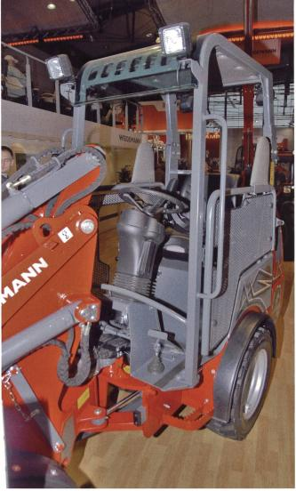
Les chargeurs de ferme construits en 2010 ne sont commercialisables qu'avec une cabine de protection du chauffeur testée. Selon les directives de prévention des accidents, un système de retenue est nécessaire, une ceinture de sécurité ne suffit pas.
