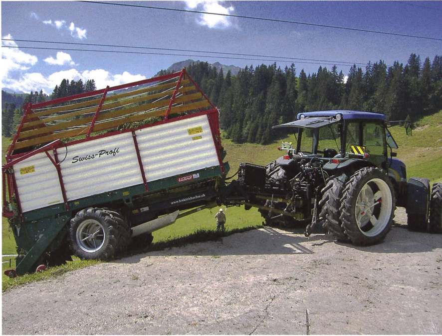
La modification de l'angle entre le timon et la machine permet un travail propre dans les bosses et les creux. (Photo : Schmid Landmaschinen, Littau)
