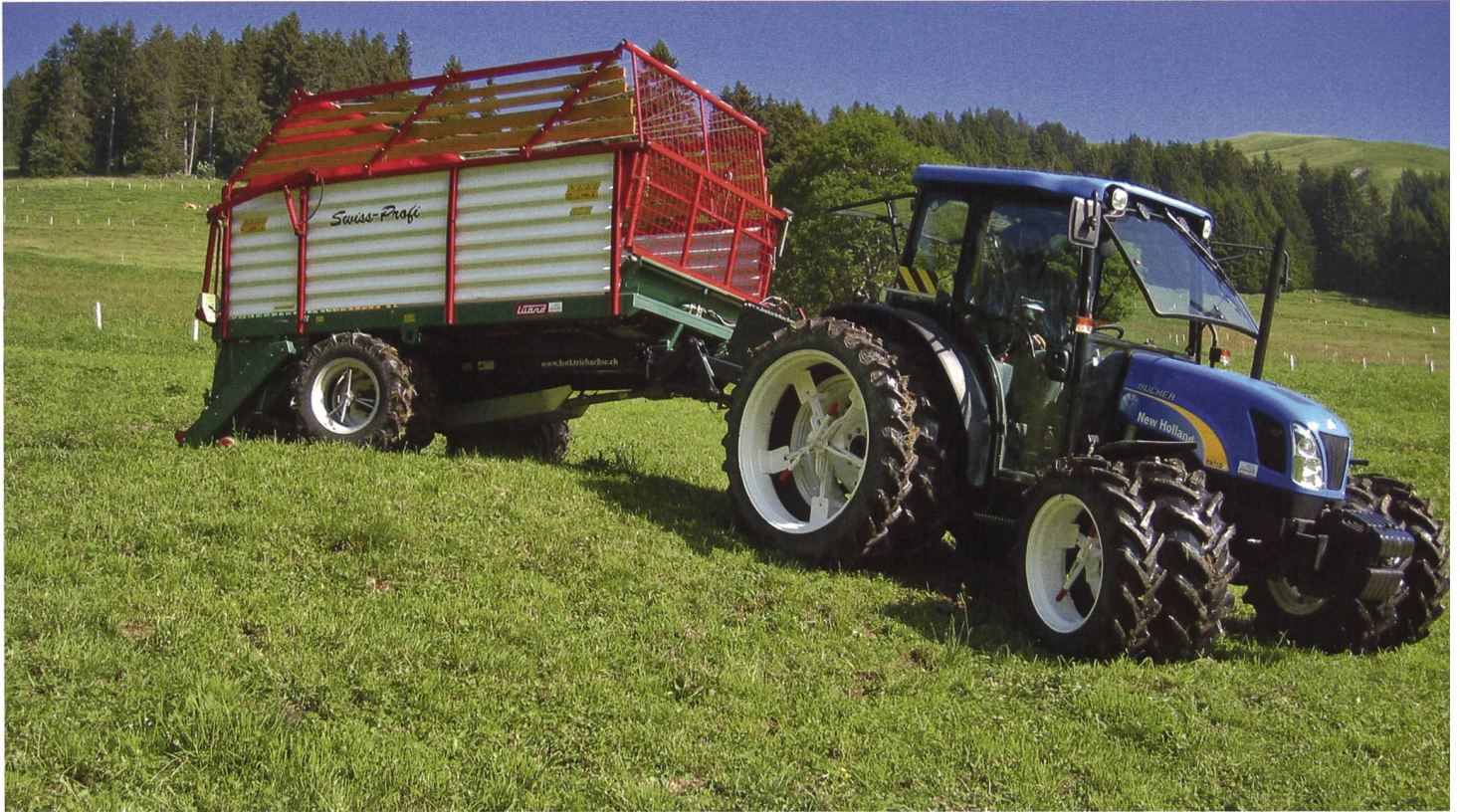
La récolte des fourrages en montagne exigent des machines adaptées et sûres. Les remorques à essieux dirigés et entraînés peuvent dans certains cas améliorer la polyvalence du tracteur. (Photo : Schmid Landmaschinen, Littau)
