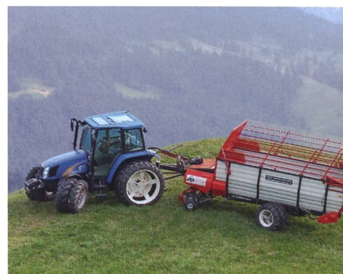
Le guidage des essieux améliore la manœuvrabilité des remorques. (Photo : Schmid Landmaschinen, Littau)
