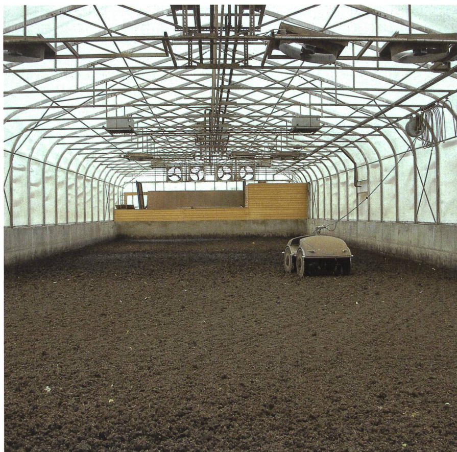
Récupération de la chaleur pour le séchage du digestat sous serre, conditionné ensuite en engrais pour jardin.
