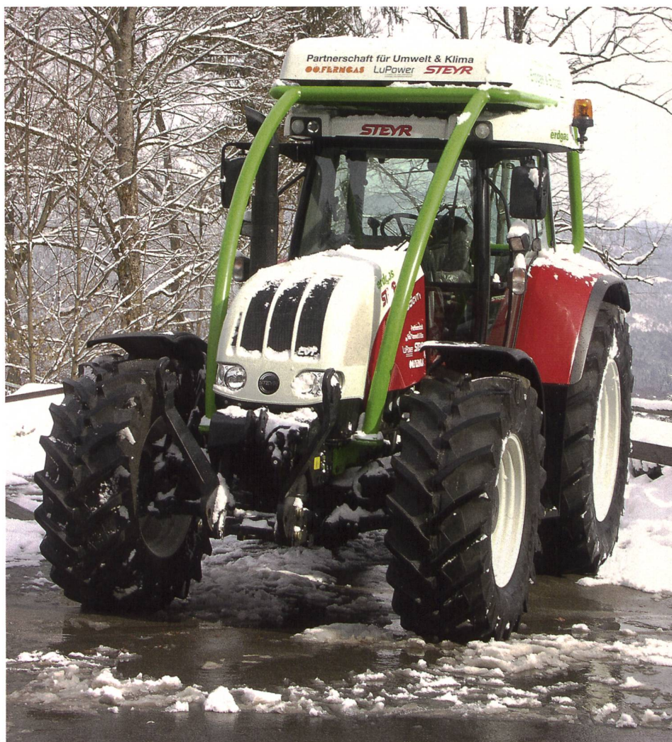
Tracteur alimenté par du biogaz (source Steyr).
