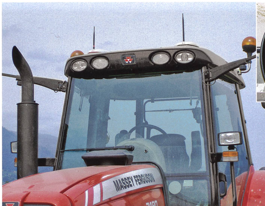
Le Leica mojoGlide est un système de guidage à double fréquence, avec une précision de 15 à 25 cm sans utiliser de base stationnaire. (photos Ruedi Hunger)
