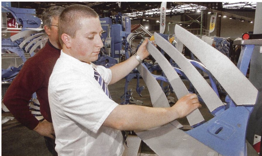
Les socs à lamelles en aciers spéciaux ne sont plus vissés, mais simplement accrochés par un dispositif spécial.
