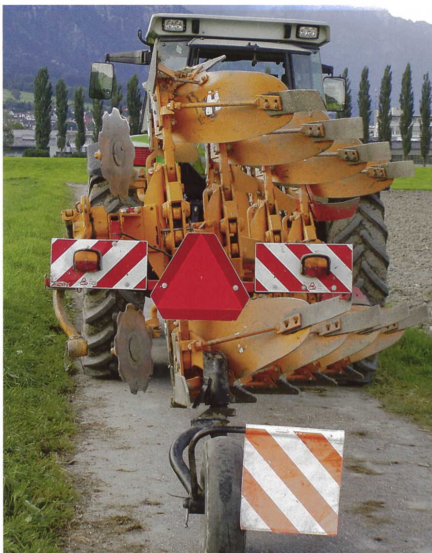
Les charrues multisocs cachent toujours les feux de signalisation arrière du tracteur, raison pour laquelle il faut les équiper d'un éclairage d'appoint. (Photos: Ruedi Hunger)
