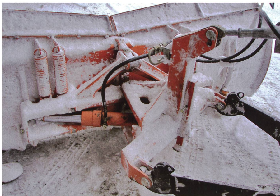
Système de déclenchement et de pivotement d'une lame pour relevage frontal. (photo: Gaël Monnerat)
