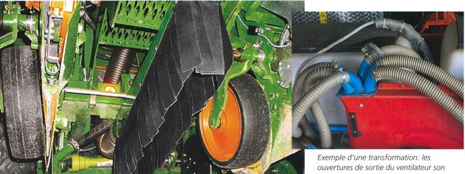
Exemple d'un déflecteur sur un semoir de précision. L'air expulsé est dévié par des tuyaux volumineux du ventilateur jusqu'à un dispositif spécifique monté à proximité du sol. (Photo d'usine Amazone)
