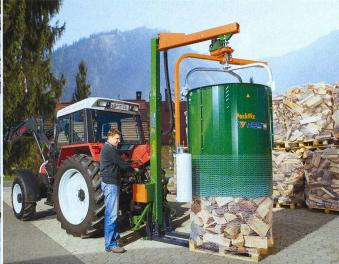
Paquetage de bûches maniable, par exemple avec le Packfix de Posch. (Photo d'usine)
