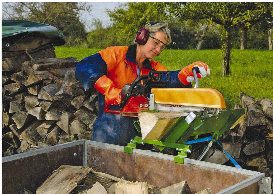
Sciage à la tronçonneuse. Le service de prévention des accidents dans l'agriculture (SPAA) recommande l'usage d'un tréteau avec dispositif de maintien comme mesure de prévention (photo: SPAA).
