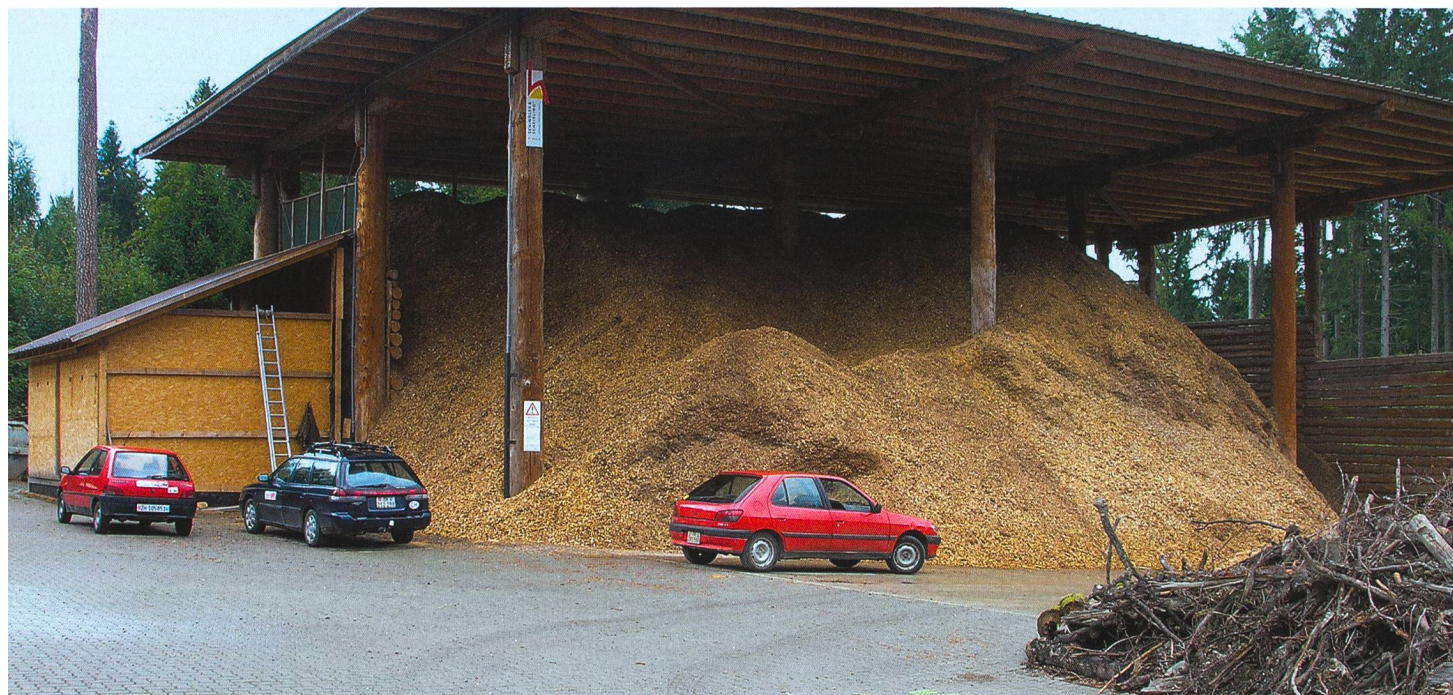
Installation d'essai de séchage de bois de cheminée avec panneaux solaires. L'objectif consiste à remplir le séchoir en mars et de pouvoir reprendre les bûches sèches fin août. (Photos: Ruedi Gnädinger)
