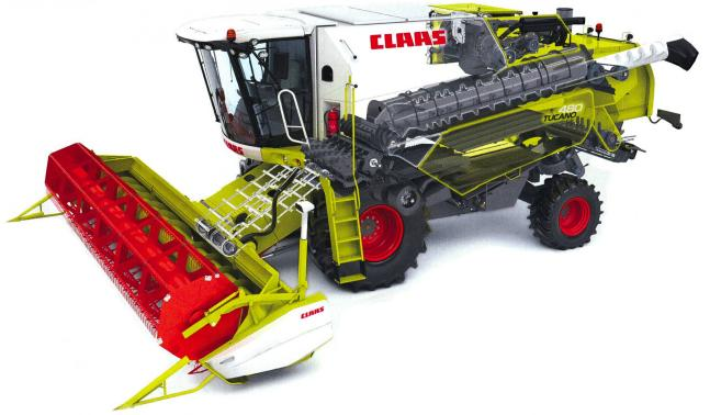
APS + ROTO PLUS = HYBRID SYSTEM, telle est la formule de Claas. Les deux modèles de pointe TUCANO 470 et 480 travaillent avec un seul rotor long de 4,20 m. (Photos d'usine)
