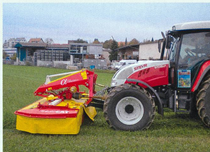
Alpha motion: attelage mille fois éprouvé pour faucheuse à disques avant.
