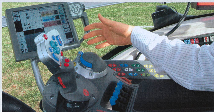
Variotronic, monté sur la série 800 Vario. Une abondance d'éléments de guidage et de contrôle facilement accessibles.
