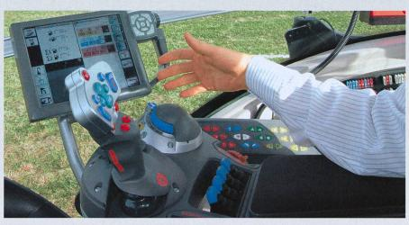
Variotronic, monté sur la série 800 Vario. Une abondance d'éléments de guidage et de contrôle facilement accessibles.
