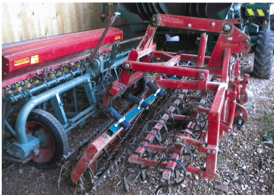
Combinaison de semis « maison », un ancien Nodet et un attelage sur un vibro-culteur.
