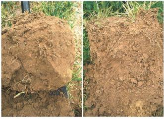
Fig. 1: Test de la bêche dans un champ CTF au Danemark. À gauche: tassement dans la voie de passage et mauvais enracinement. À droite: structure du sol grumeleuse avec fort développement de racines. (Photos: Agroscope ART)
