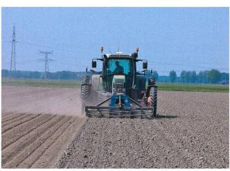
Fig. 2: Les systèmes CTF originels nécessitent des voies de passage uniques. Tracteur avec voie élargie pour semis monograine de léaumes en Hollande.
