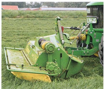
équilibrage intégré par ressorts et un nouveau système cinématique à rappel dénommé «EasyCut 32 CV Float». Cet attelage présent pour la première fois les avantages d'un attelage poussé et d'un attelage traîné sans augmenter la charge sur l'essieu avant.
