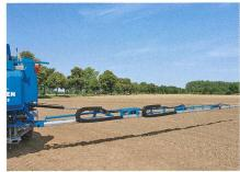
Lemken GmbH apporte deux nouveautés primées à ses pulvérisateurs: «Rampe de pulvérisation réglable en continu LEMKEN VariExtend». Cette rampe coulissante adapte la largeur de travail en continu. Cette fonction permet d'éviter les obstacles sans avoir à sortir des traces de passage et d'adapter la largeur de travail en bordure de champ.
