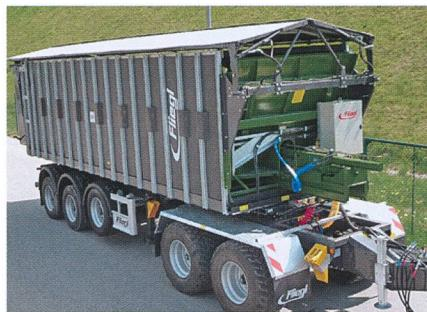
**Fliegl Agrartechnik GmbH** équipe ses remorques du nouveau système «Toit relevable Toplift». Ce système assure une couverture des remorques rapide et sans danger. Il évite ainsi les pertes de matériel dues au vent ainsi que la contamination des récoltes par les fientes d'oiseaux.
