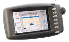
ISOBUS». Il s'agit du premier système plug-and-go de guidage à ne pas être conçu spécifiquement pour un type de tracteur. La commande du système de direction est gérée par n'importe quel terminal isobus. Ce système est universel et équipe tous les véhicules disposant d'un terminal isobus.
