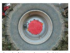
**Grasdorf Wennekamp GmbH** améliore la préservation avec le «*Soil Load Monitor (SLM)*». La pression des pneumatiques est gérée automatiquement en fonction de la charge et de la vitesse suivant les indications d'un capteur à ultrason positionné dans la jante.
