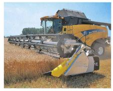
La conception de l'«Ultralight 800» de **Biso Schrattenecker GmbH** constitue une évolution technique qualifiée d'exemplaire. Le bec récolteur pour moissonneuse-batteuse est constitué d'éléments en aluminium creux assemblés par vissage et brevetés. Grâce à cette construction modulaire, le poids des organes de coupe est fortement diminué. Tous les réglages de ce nouveau bec récolteur d'une largeur de 12 m sont soit électro-hydrauliques, soit par broches centrales.
