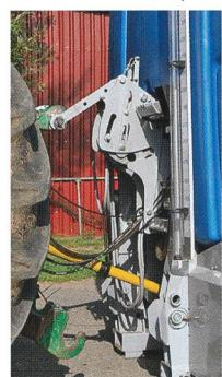
La deuxième amélioration concerne l'attelage des pulvérisateurs. «LEMKEN Connect» facilite le branchement du troisième point des prises de forces hydrauliques et électriques en laissant une certaine distance entre le tracteur et le pulvérisateur. L'attelage des bras inférieurs est automatique.
