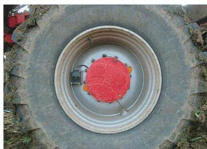
**Grasdorf Wennekamp GmbH** améliore la préservation avec le «Soil Load Monitor (SLM)». La pression des pneumatiques est gérée automatiquement en fonction de la charge et de la vitesse suivant les indications d'un capteur à ultrason positionné dans la jante.
