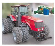
Le «Belarus 3023», développé par **Traktorenwerk Minsk** et d'une puissance avoisinant les 300 ch., est un tracteur standard propulsé par un moteur diesel-électrique. Ce tracteur dispose d'une électronique de commande moderne, d'une prise de force frontale à entraînement électrique (donc largement indépendante du régime moteur) et d'un réseau interne de courant à haute tension permettant de délivrer jusqu'à 172 kW (234 ch.) aux consommateurs externes.
