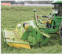
équilibrage intégré par ressorts et un nouveau système cinématique à rappel dénommé «EasyCut 32 CV Float». Cet attelage présent pour la première fois les avantages d'un attelage poussé et d'un attelage traîné sans augmenter la charge sur l'essieu avant.
