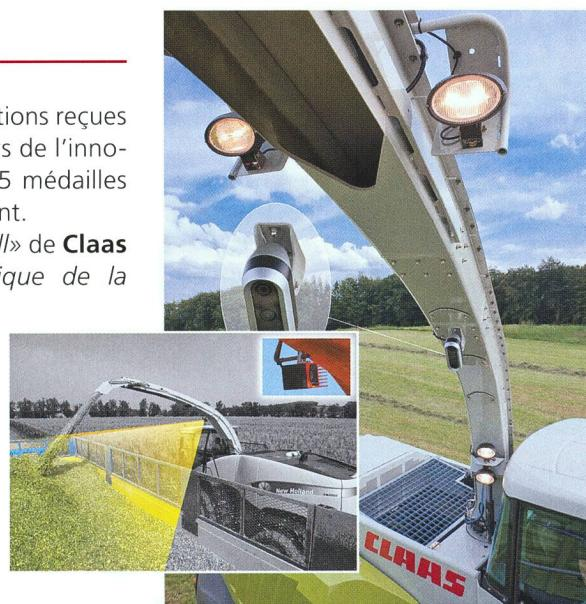
sa forme et du niveau de remplissage. Fonctionnant aussi bien de nuit que par temps brumeux, ces systèmes évitent aux chauffeurs de surveiller le processus de remplissage, ce qui améliore le confort et la sécurité au travail.
