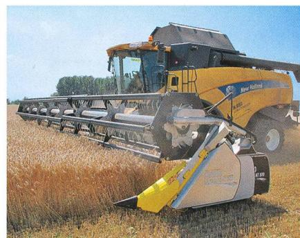
La conception de l'«Ultralight 800» de **Biso Schrattenecker GmbH** constitue une évolution technique qualifiée d'exemplaire. Le bec récolteur pour moissonneuse-batteuse est constitué d'éléments en aluminium creux assemblés par vissage et brevetés. Grâce à cette construction modulaire, le poids des organes de coupe est fortement diminué. Tous les réglages de ce nouveau bec récolteur d'une largeur de 12 m sont soit électro-hydrauliques, soit par broches centrales. ■
