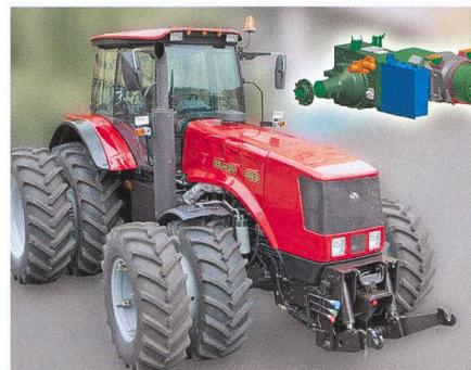
Le «Belarus 3023», développé par **Traktorenwerk Minsk** et d'une puissance avoisinant les 300 ch., est un tracteur standard propulsé par un moteur diesel-électrique. Ce tracteur dispose d'une électronique de commande moderne, d'une prise de force frontale à entraînement électrique (donc largement indépendante du régime moteur) et d'un réseau interne de courant à haute tension permettant de délivrer jusqu'à 172 kW (234 ch.) aux consommateurs externes.
