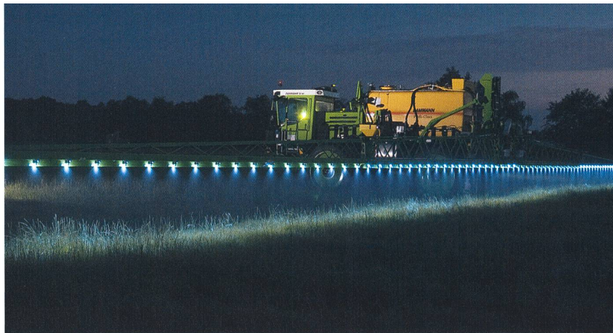
La combinaison des technologies GPS et LED permet les traitements de nuit en toute sécurité.
