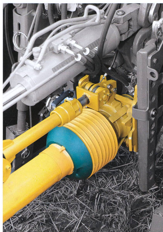
Couplage automatique de la prise de force selon Walterschied.
