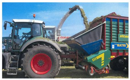
Augmenter les capacités de transport par le tassement de la récolte dans les remorques, une nouvelle approche...
