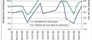
Fig. 8: Les résultats d'essai indiquent une relation évidente entre le rendement électrique et la vitesse de l'air dans le collecteur.
