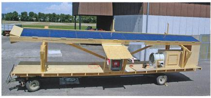
Fig. 3: L'installation d'essai (installation PV) d'ART se compose de huit modules photovoltaïques, intégrés à la toiture (20°). Un ventilateur (en bas à droite) avec débitmètre en amont permet de régler la vitesse de l'air en continu entre 1 et 7 m/s.
