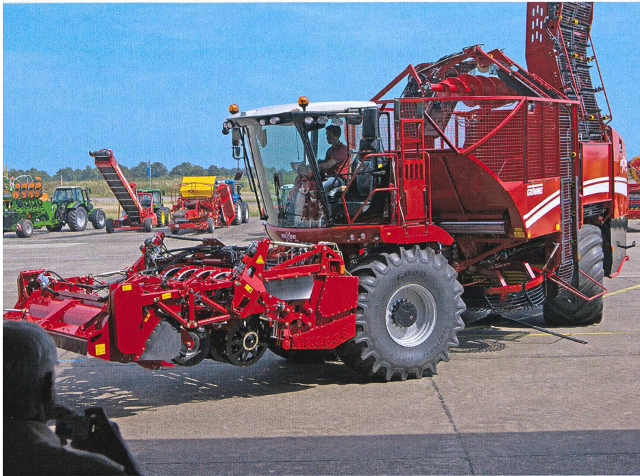
Rexor 620 avec direction articulée et essieux directionnels pour des rayons de braquage étroit. (Photo: Ueli Zweifel)
