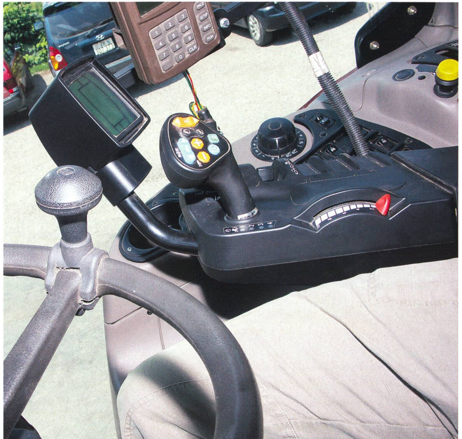
Détails de l'accoudoir droit du siège: le levier Multicontroller V avec commande des vitesses, inverseur de marche, relevage et distributeur hydraulique.
