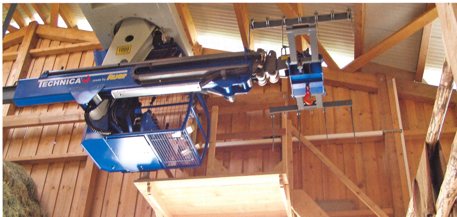
Les griffes à tourelles: à intégrer de manière optimale dans les nouveaux bâtiments. (Photos: Ruedi Hunger)
