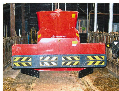
Fig. 8: La mélangeuse verticale sur rails (Triomatic) est équipée de deux vis de mélange et possède une capacité de 3 mètres cubes. Etant donné ses 1,35 mètres de large et ses 3,13 mètres de long, elle nécessite une table d'affouragement suffisamment large.
