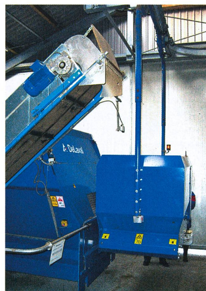
Fig. 9: Une mélangeuse fixe (DeLaval) produit la ration mélangée. Puis, le dispositif d'alimentation remplit le chariot distributeur. Des capteurs assurent un dosage correct.
