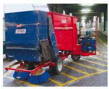
Fig. 4: Le chariot distributeur automatique (Cormall) charge la ration depuis la mélangeuse fixe et se déplace ensuite automatiquement pour distribuer le fourrage. Il est entraîné par un moteur diesel. Les brosses radiales dont il est équipé lui permettent de repousser le fourrage à tout moment.
