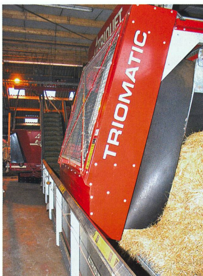
Fig. 11: Le système de dosage de Triomatic se compose d'un cadre de coupe (à gauche), d'un tapis de pesée et de convoyage et de plusieurs tables de réserve et d'amenée pour les composants des fourrages (à droite). Le cadre de coupe peut recevoir des blocs d'ensilage et des grosses balles et couper le fourrage à la longueur voulue.
