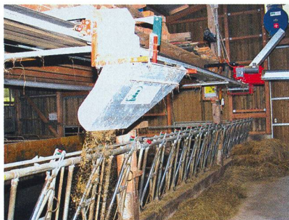
Fig. 3: Les tapis d'affouragement distribuent des composants de fourrage séparés ou mélangés. Ils sont placés soit au-dessus de la tête des animaux (à gauche et au centre) ou dans la crèche (à droite). Ils peuvent être installés directement lors de la construction du bâtiment (à gauche et au centre) ou rajoutés a posteriori.
