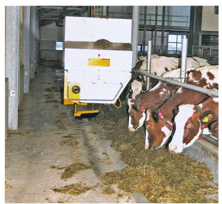
Fig. 1: Les systèmes d'affourragement automatique approvisionnent plusieurs groupes d'animaux en fourrage fraîchement mélangé 24 heures sur 24.
