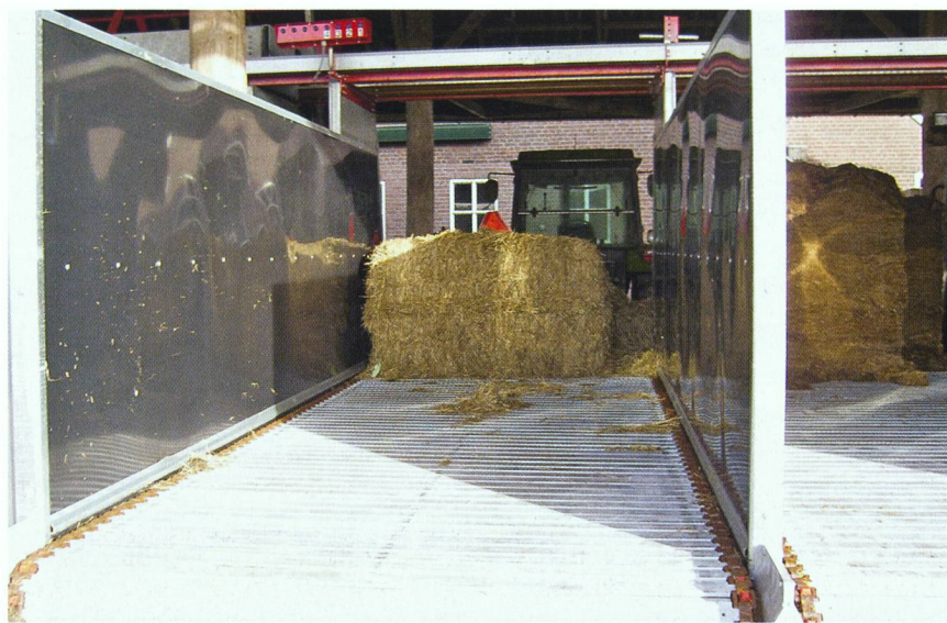
Fig. 11: Le système de dosage de Triomatic se compose d'un cadre de coupe (à gauche), d'un tapis de pesée et de convoyage et de plusieurs tables de réserve et d'amenée pour les composants des fourrages (à droite). Le cadre de coupe peut recevoir des blocs d'ensilage et des grosses balles et couper le fourrage à la longueur voulue.
