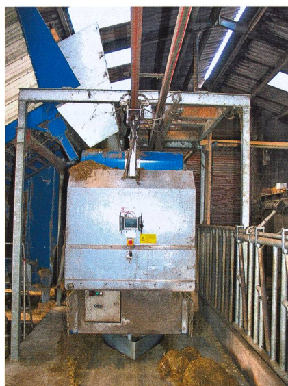
Fig. 6: Le RobotFeeder (Pellon) va chercher les composants dans les conteneurs de fourrage et les mélange déjà pendant le remplissage à l'aide d'une chaîne mélangeuse et d'une vis horizontale. Le fourrage est ensuite éjecté du côté gauche ou droit du robot au moyen d'une vis centrale et d'un tapis roulant.
