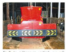
Fig. 8: La mélangeuse verticale sur rails (Triomatic) est équipée de deux vis de mélange et possède une capacité de 3 mètres cubes. Etant donné ses 1,35 mètres de large et ses 3,13 mètres de long, elle nécessite une table d'affourragement suffisamment large.
