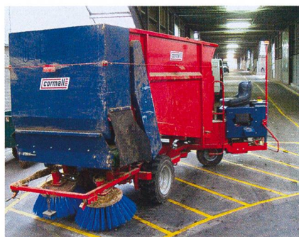
Fig. 4: Le chariot distributeur automatique (Cormall) charge la ration depuis la mélangeuse fixe et se déplace ensuite automatiquement pour distribuer le fourrage. Il est entraîné par un moteur diesel. Les brosses radiales dont il est équipé lui permettent de repousser le fourrage à tout moment.
