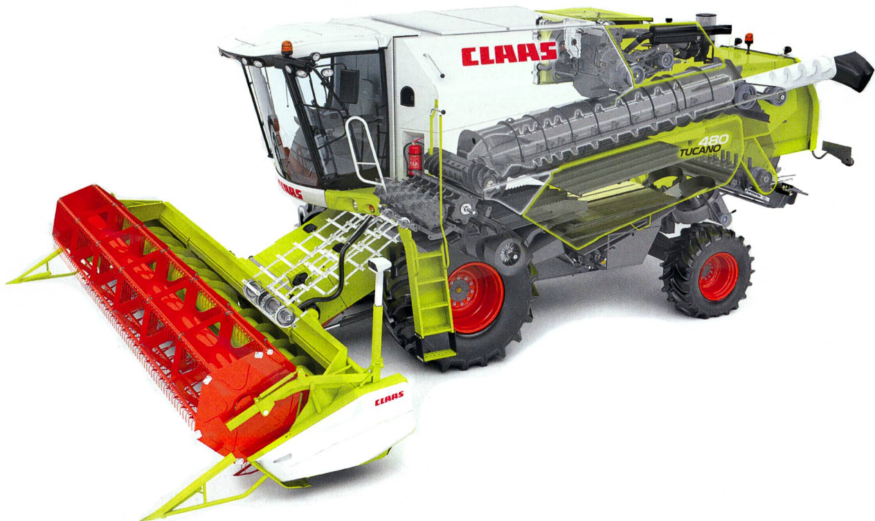
APS + ROTO PLUS = HYBRID SYSTEM, telle est la formule de Claas. Les deux modèles de pointe TUCANO 470 et 480 travaillent avec un seul rotor long de 4,20 m. (Photos d'usine)
