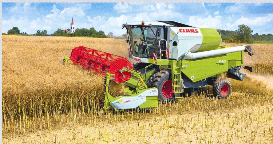
La nouvelle AVERO 240: Système de battage APS maintenant dans la classe des machines à 4 secoueurs.
