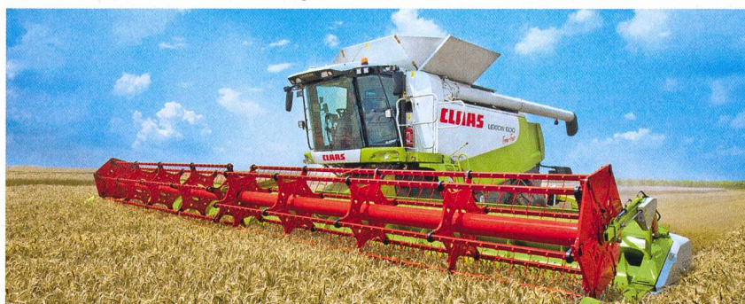
Lexion 600 TERRA TRAC avec le nouveau dispositif de coupe Vario V1200.
