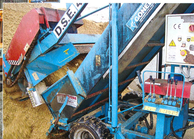
Désileuse électrique avec convoyeur dans le silo-tranchée.
