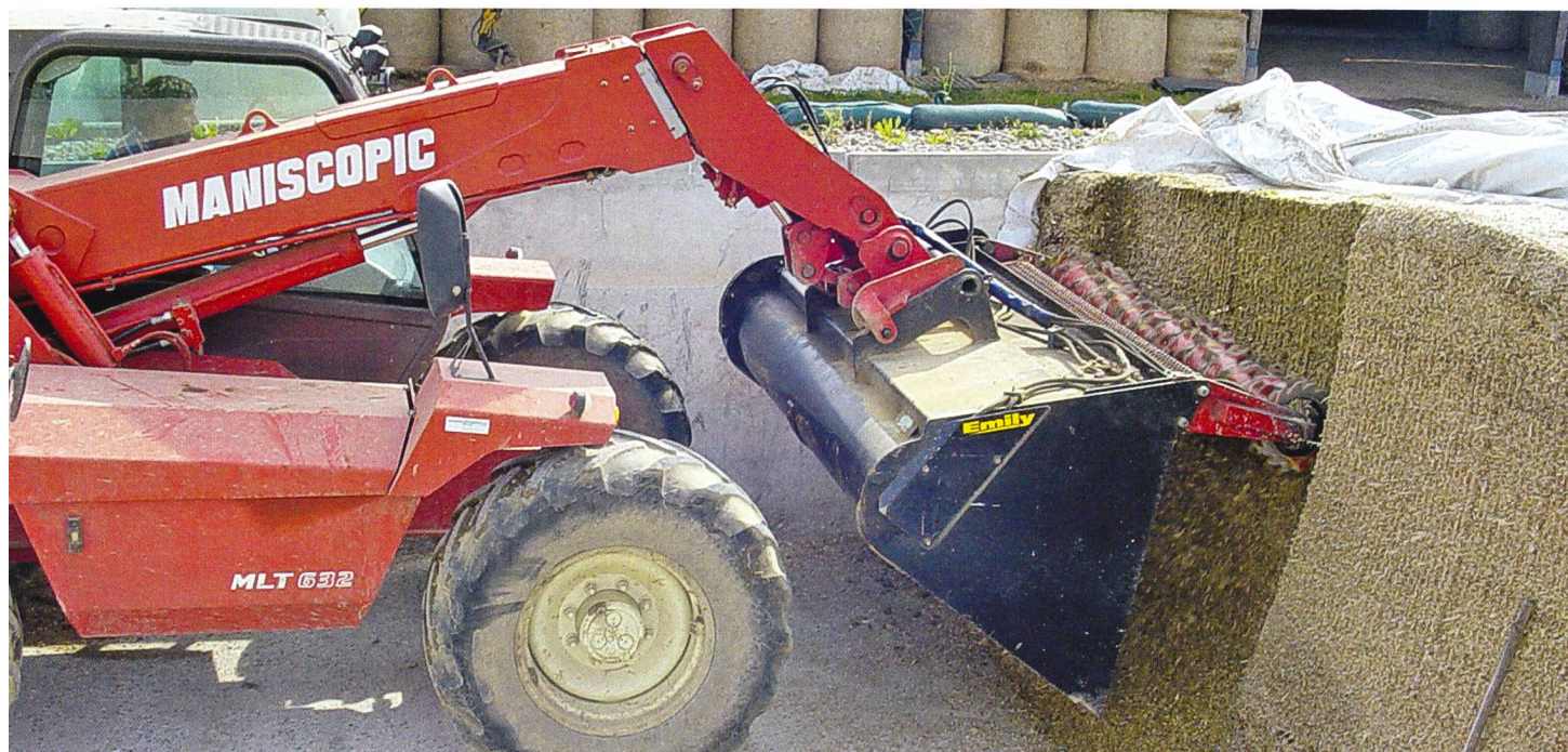
Pelle de répartition d'ensilage pour la reprise et la distribution de l'ensilage de maïs. (Photo: Konrad Merk)
