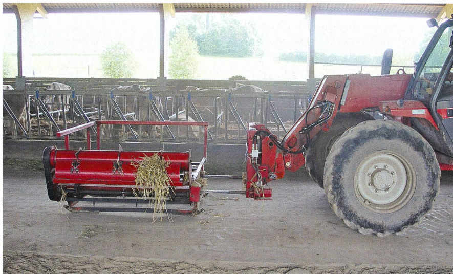
Dérouleuse de balle avec broche intégrée. (Photo: Konrad Merk)
