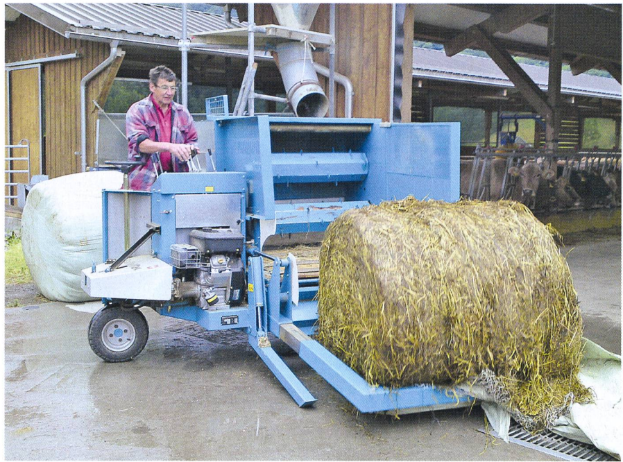
Dérouleuse de balle automotrice avec dispositif de levage. (Photos: Andreas Caduff)
