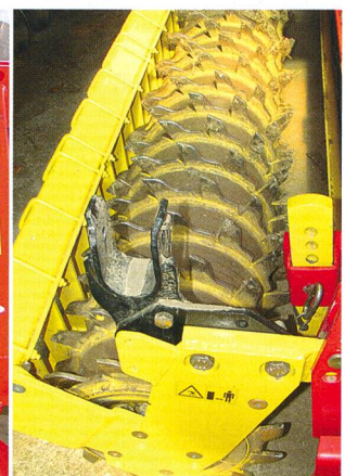
Montage en combinaison et en intégration sur rouleau packer. (Photos: Gaël Monnerat)
