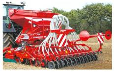
L'i-drill Pro est également livrable avec l'appareil de commande de dosage électrique, ce qui implique la capacité ISOBUS de la machine.
