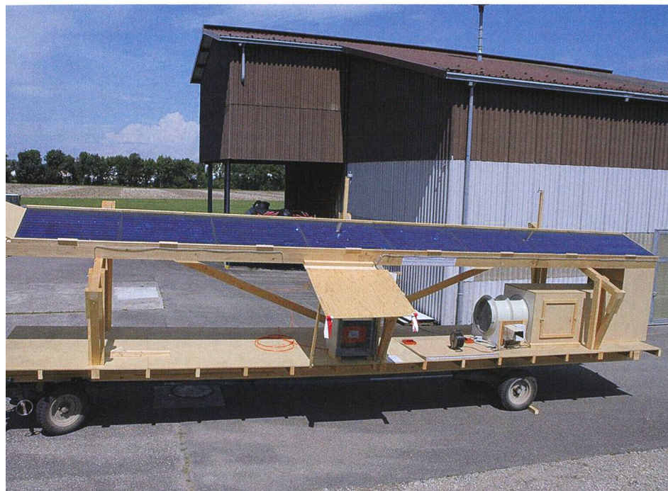
Installation-pilote avec 8 modules photovoltaïques intégrés dans le toit. (Photo: ART)
