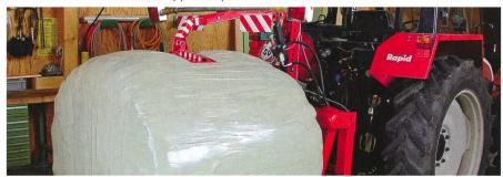
Fourche à balles avec bras hydraulique pour des transports légalement corrects.
