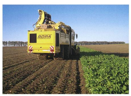
Pression des pneumatiques, charge par roue, et nombre de passages déterminent l'impact au sol d'une machine.
