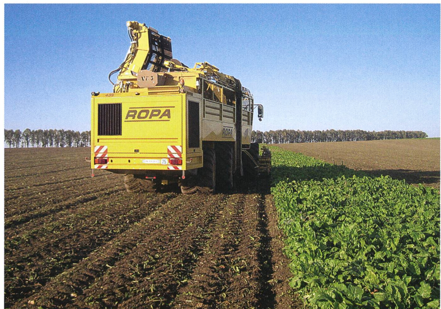
Pression des pneumatiques, charge par roue, et nombre de passages déterminent l'impact au sol d'une machine.
