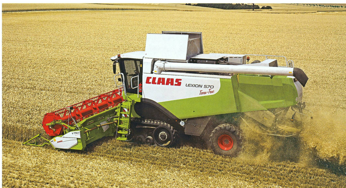
Les trains de chenilles sont également des équipements qui peuvent limiter le tassement du sol.
