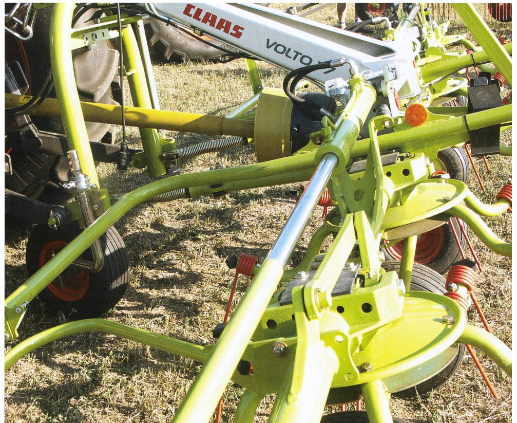
Des toupies de petit diamètre à cinq bras pour une reprise et une répartition optimale du fourrage. Des stabilisateurs évitent les oscillations pendant le travail.
