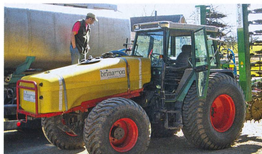
Tracteur avec réservoir pour le sulfate d'ammonium. L'engrais liquide est livré par camion citerne.
