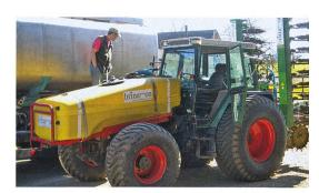
Tracteur avec réservoir pour le sulfate d'ammonium. L'engrais liquide est livré par camion citerne.
