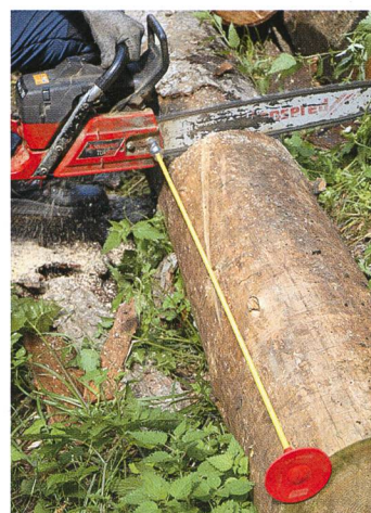
Le CUTCONTROL, un instrument relativement peu connu, mais très utile pour fixer la longueur des bois.
