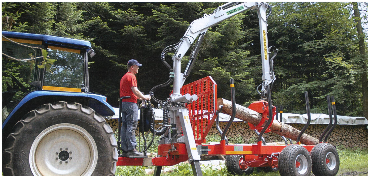
Grue de débardage: Personne ne doit se trouver dans le rayon d'action de la machine. (Photos: SPAA)
