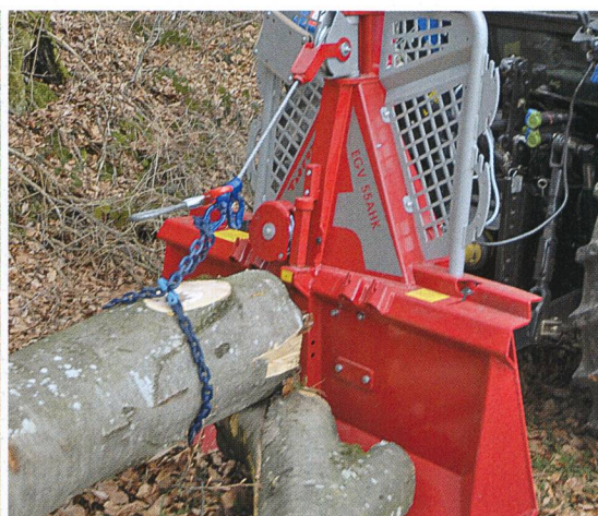
Ces dernières années, les treuils ont été fortement améliorés sur les plans de la sécurité et de l'ergonomie. Une commande par radio facilite le travail, mais pose des exigences élevées à son utilisateur.
